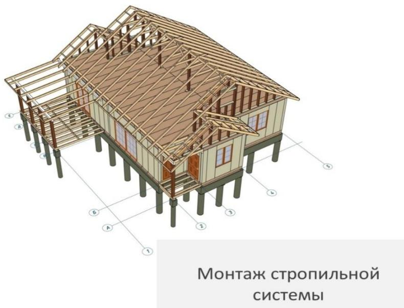
**Рис. 2. Установка стропильной системы**
