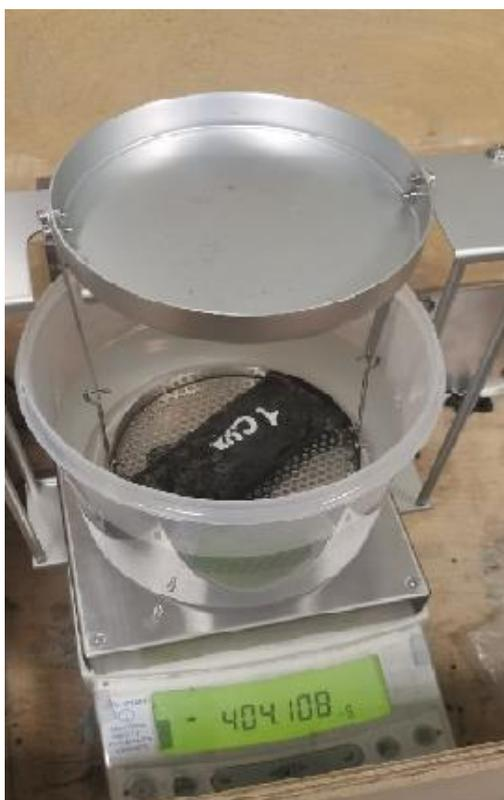
**Рис.3. Измерение массы влажного брикета в воде**
