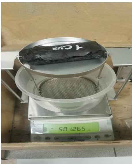
Рис.1. Определение массы сухого брикета
