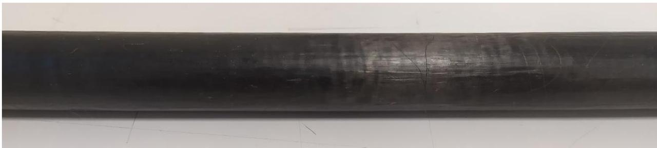
**Рис. 2. Готовая труба из ПКМ**
